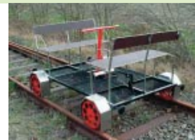
Neue Krafteinfahrung mit der Handhebeldraisine.
