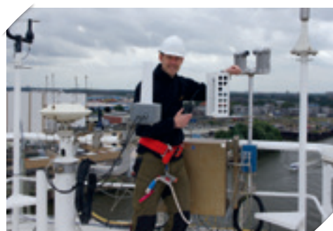
Ausgerüstet für neue Fahrwasser Die Installation des OceanRAIN-Disdrometers an Bord der „Meteor“ im Hamburger Hafen im August 2014
